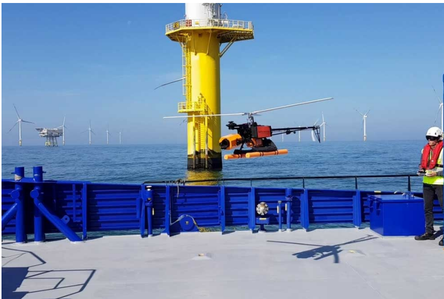
Der AERO-SensorCopter startet zu seinem Wartungsflug an einer Offshore-Anlage
