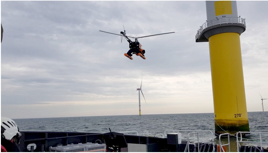
Die Hubschrauber-Drohne erstellt auch bei Windgeschwindigkeiten von bis zu 14 Metern pro Sekunde hochauflösendes Bildmaterial
